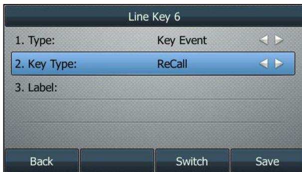
6. Premere il tasto softkey **Save** per accettare la modifica oppure il tasto softkey **Back** per annullare l'operazione.
